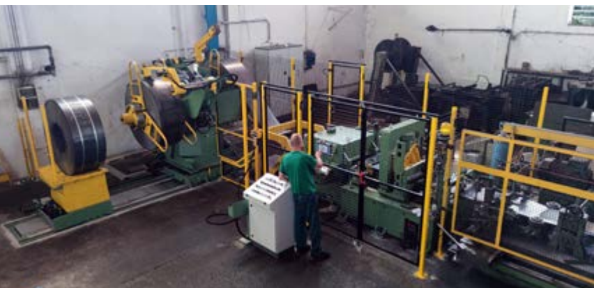
Vista della parte iniziale della linea di profilatura che permette al Tubificio Lombardo di trasformare a freddo lamiera da coil in tubi fino a 7,5 m di lunghezza
